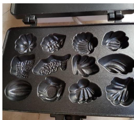
ลักษณะแม่พิมพ์ขนมอบที่มีพื้นที่ผิวสัมผัสอาหารบางส่วน (Surface area exposed < 100 %)
